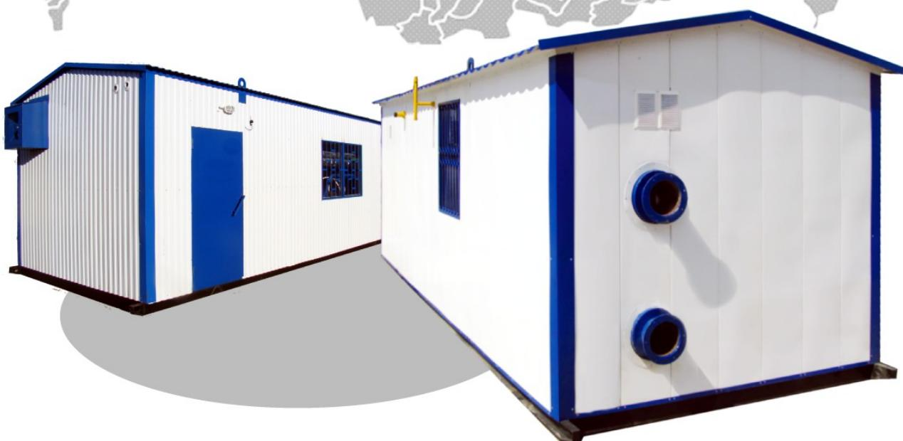
**Пункты газорегуляторные шкафные** предназначены для снижения давления природного газа до значений, пригодных для использования потребителем, автоматического поддержания давления в нужном режиме и отсечения подачи газа в случае повышения или понижения выходного давления, вызванных аварийной ситуацией.
